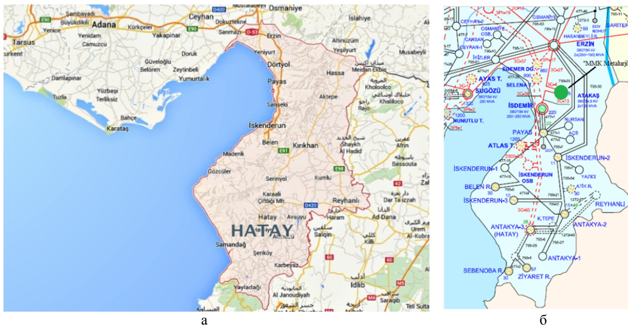
Рис. 1. Карта провинции Хатай Турецкой республики (а) и схема районных электрических сетей 380 кВ (б)
