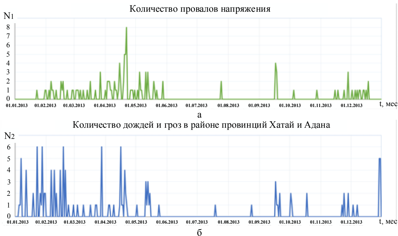
Рис. 6. Графики возникновения провалов напряжения в течение 2013 года (а); графики возникновения дождей и гроз в районе провинций Хатай и Адана (б)
